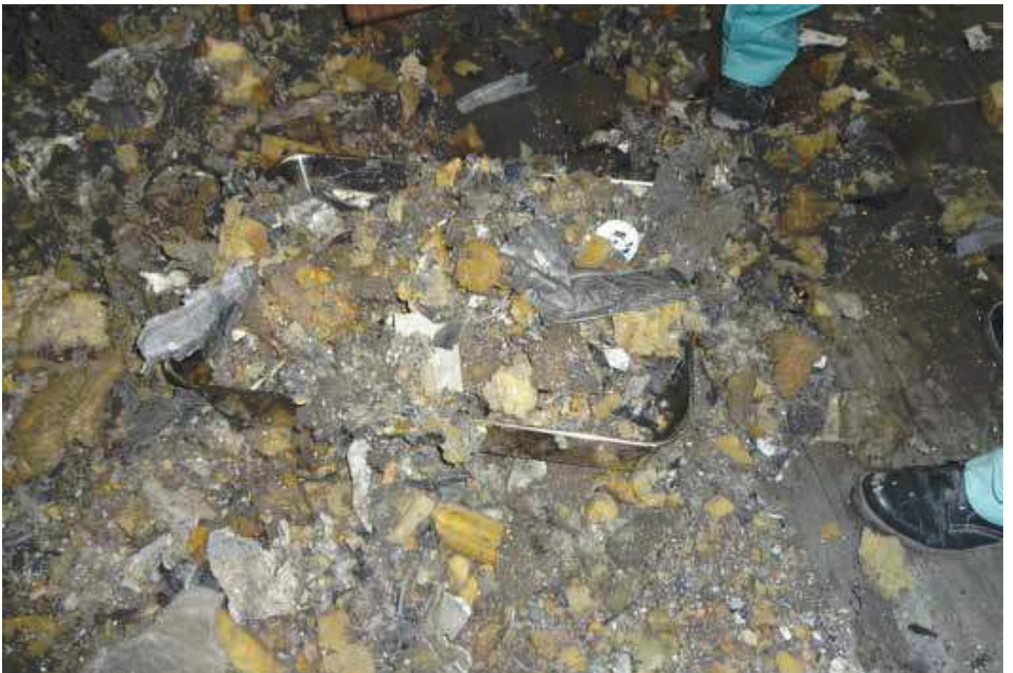
自動車シュレッダーダスト(ASR)——上, 下とも愛媛県金城産業にて筆者撮影
